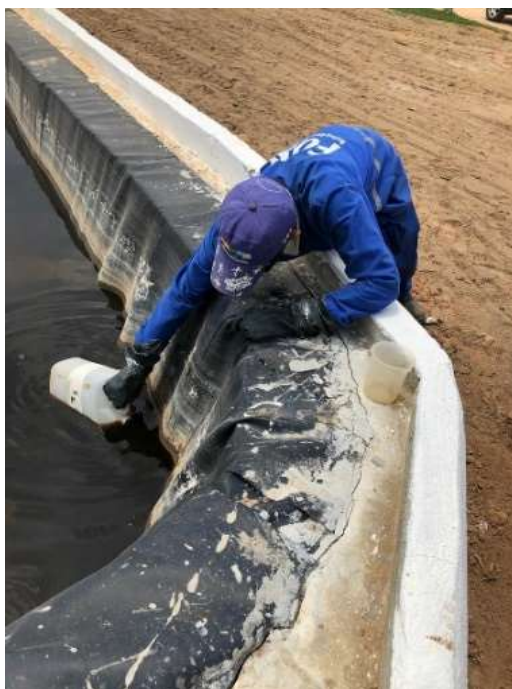
Figura 7 - Coleta de lixiviado bruto na lagoa de decantação do Aterro Sanitário Metropolitano de João Pessoa.
