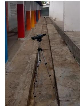
O NPS global que caracteriza um ambiente é obtido pela média logarítmica dos Níveis de Pressão Sonora contínuos equivalentes globais,  $L_{Aeq}$ , ponderada em A, e deve ser calculado através da Equação 05 a seguir, segundo a NBR 10.152 (2017):
