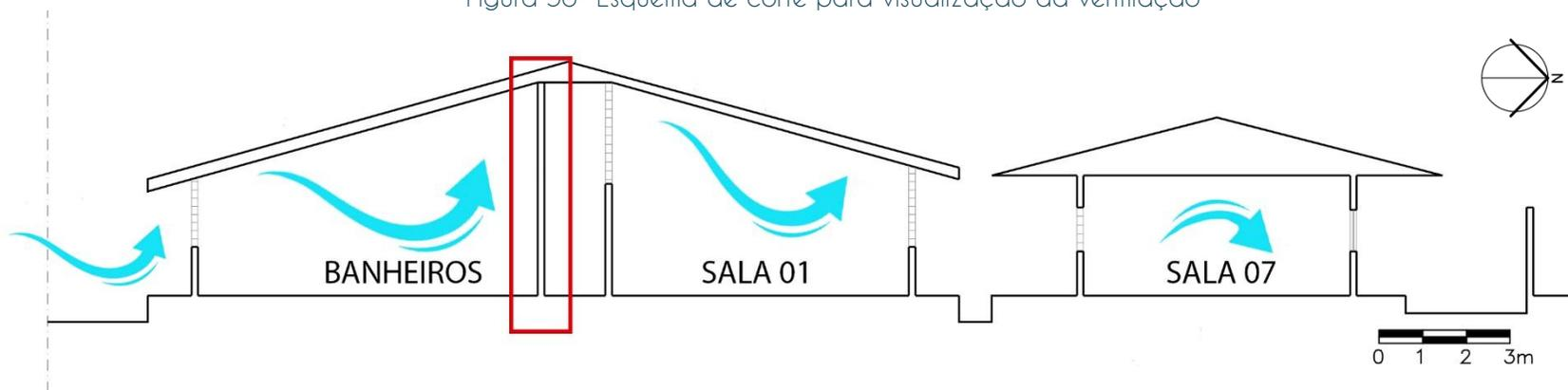
Deste modo, o primeiro passo dessa proposta consistiu em isolar as salas, substituindo os elementos vazados existentes por janelas basculantes de madeira e vidro simples na vista sul (indicado na Figura 57) e, por janelas de correr de madeira e vidro simples na vista norte, o que permite que ainda ocorra ventilação. A vedação dos elementos já é um projeto previsto pela escola, devido à pretensão da instalação de ar condicionados.
