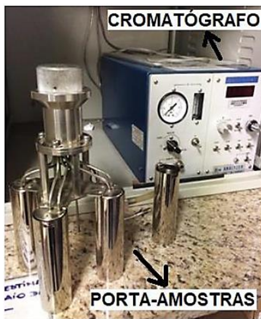
Figura 3.12 – Modelo de cromatógrafo G1006 para quantificação do hidrogênio difusível dada em ml/100g de metal fundido.
