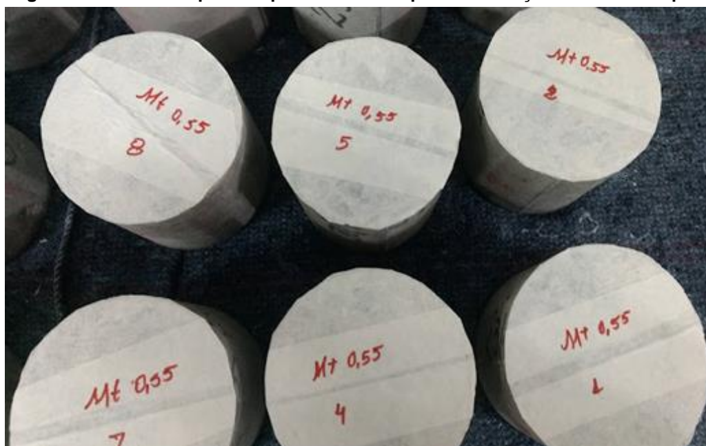
Figura 15 - Amostras prontas para iniciar a impermeabilização com resina epóxi
