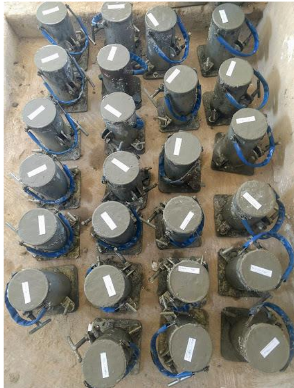
Figura 10 - Corpo de prova cilíndrico (100 X 200 mm) devidamente identificados.
