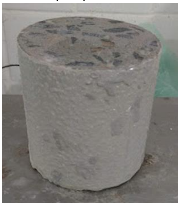
Figura 16 - Amostra pronta para início do ensaio de difusão
