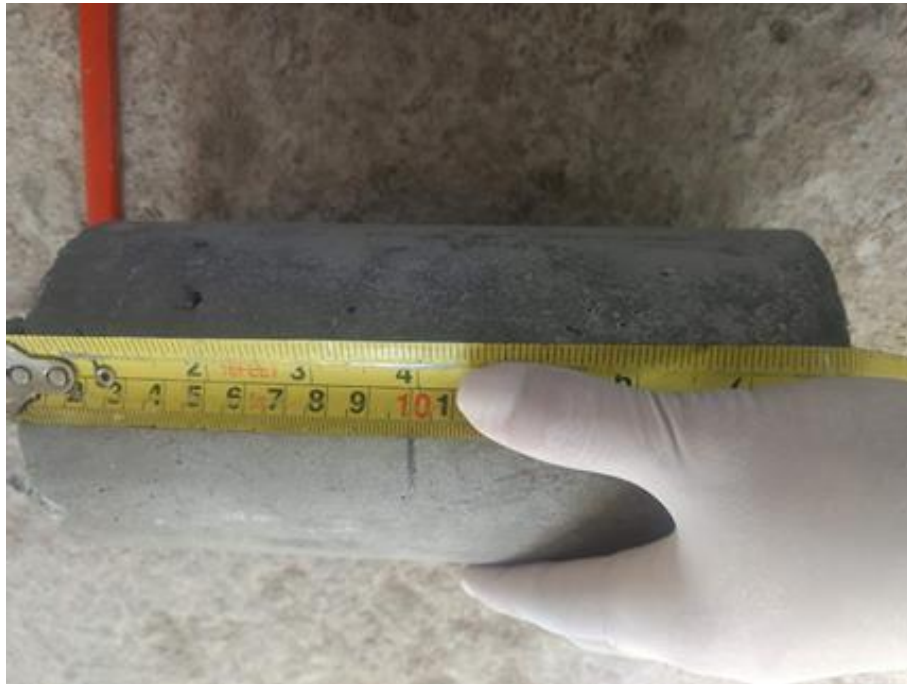
Figura 13 - Marcação de corte para obter amostra com dimensão de 100 x 100 mm
