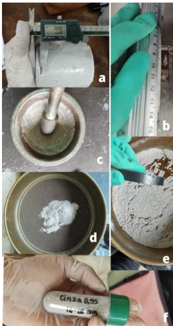
Figura 21 - Marcação das camadas na amostra (a); pulverização das amostras do concreto (b, c); peneiramento (d); retirada de resíduos metálicos provenientes da lâmina de corte (e); armazenamento de amostra para análises posteriores
