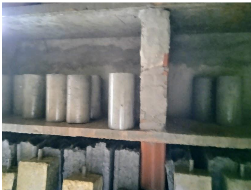
Figura 11 - Amostras de concreto ( CP cilíndrico 100 X 200 mm) armazenadas para cura
