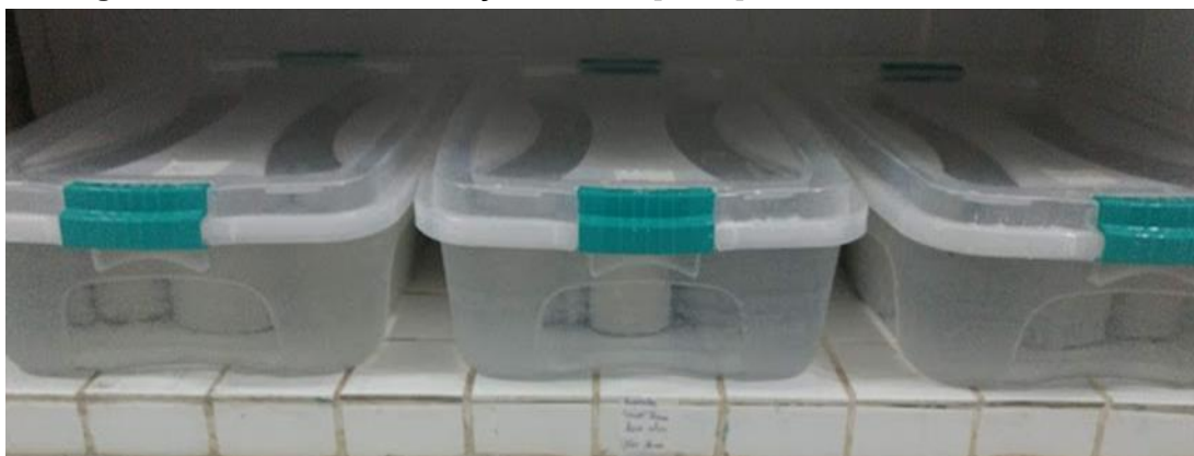
Figura 20 - Amostras em solução de NaCl [2,8 M], em ambiente de laboratório
