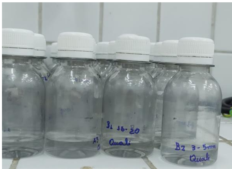
Figura 22 - Solução preparada para ensaio de titulação de acordo com as recomendações do RILEM TC 178:2012
