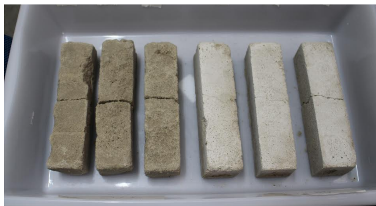
Figura 39. Barras de Argamassas de MAA a base de MK e Silicato de Sódio curados a 50°C (esquerda) e 75°C (direita) após a realização do ensaio de Flexão. Fonte: Autor (2017).
