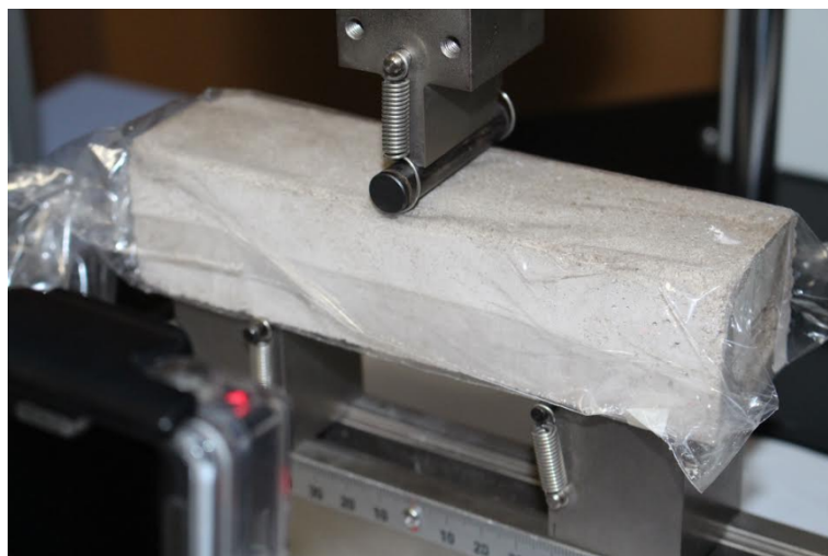
Figura 38. Barras de Argamassas de MAA a base de MK e Silicato de Sódio curados a 75°C, durante da realização do ensaio de Flexão, antes do rompimento. Fonte: Autor (2017).
