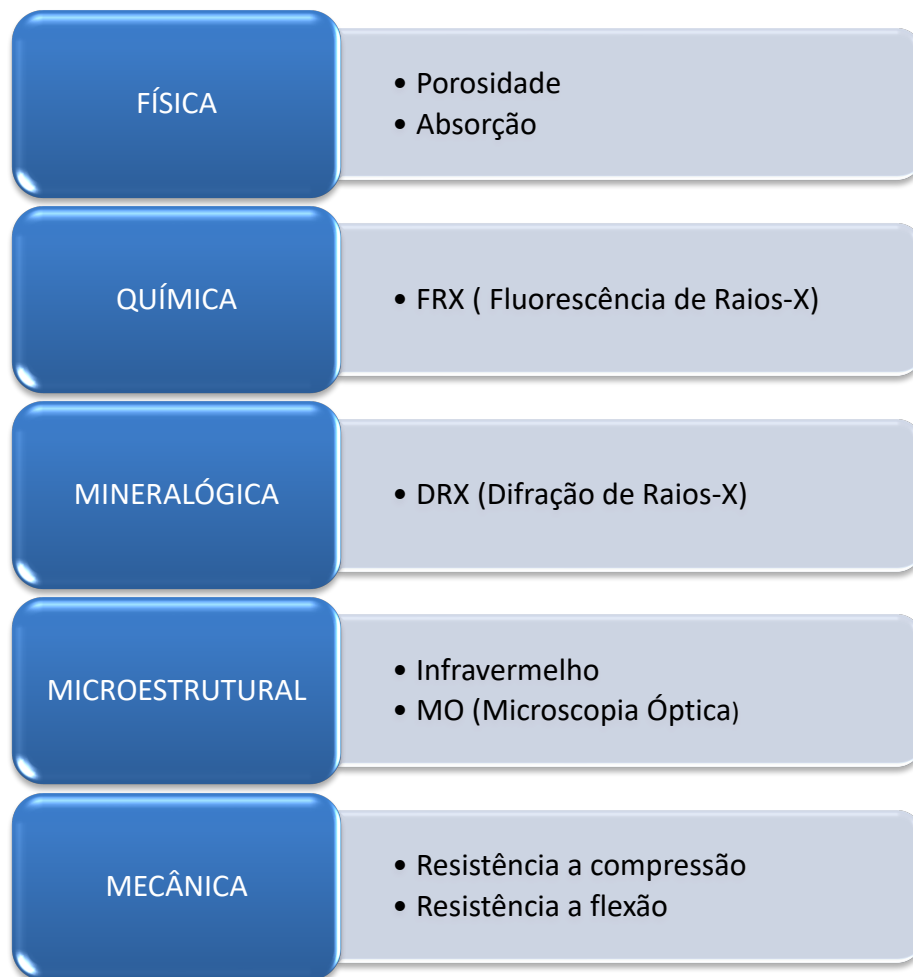
Figura 21. Caracterizações a serem empregadas no Material Precursor do MAA e nos Blocos pré-moldados fabricados. Fonte: Elaborado pelo autor (2017).
