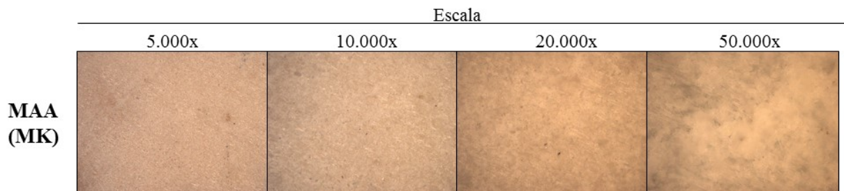
Figura 34. Micrografias do MAA a base de MK e Silicato de Sódio em diferentes ampliações.
