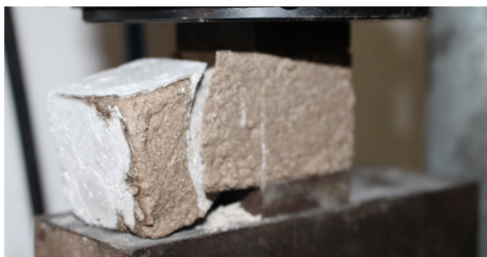
Figura 36. CP de MAA de MK+SiNa (7 dias) após a realização dos ensaios de RCS. Fonte: Autor (2018).
