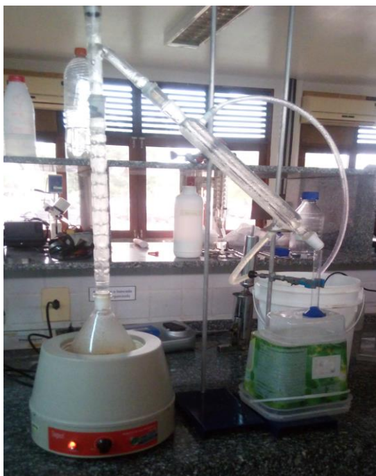
Figura 4- Processo de destilação do vinho sistema de destilação fracionada.
