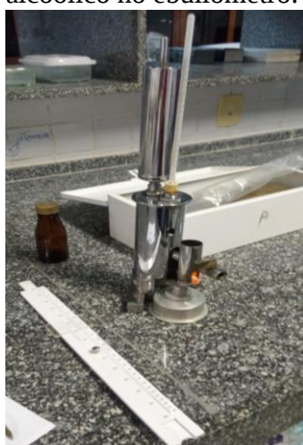
Figura 6- Processo de verificação de teor alcoólico no ebuliômetro.
