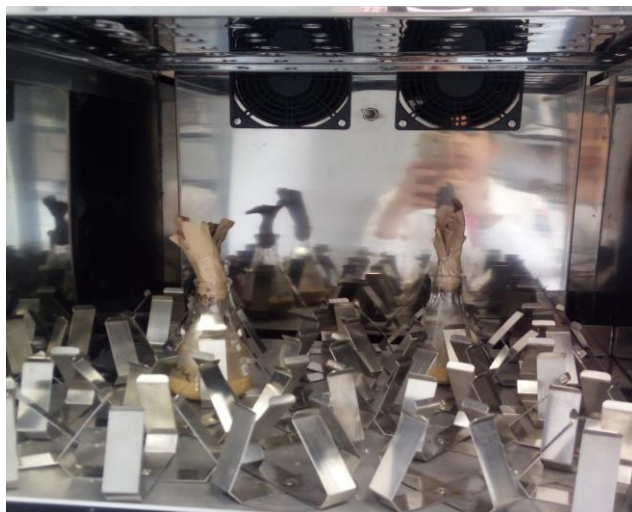
Figura 3- Processos fermentativos realizados em incubadora shaker.
