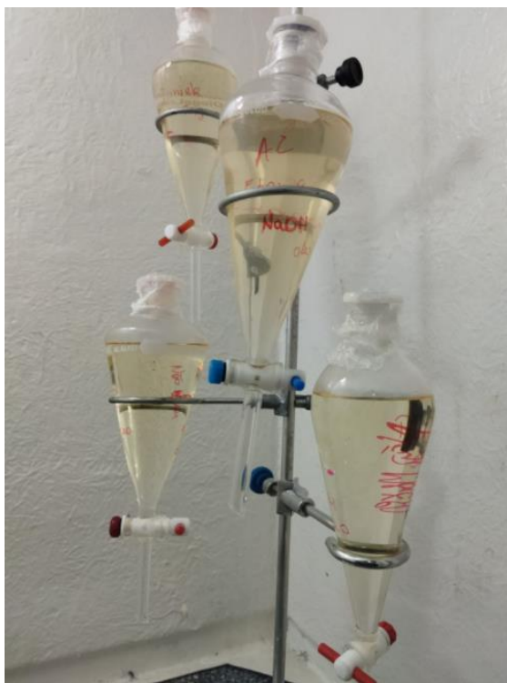
Figura 9 - Figura da produção de biodiesel (processo de separação de fases)
