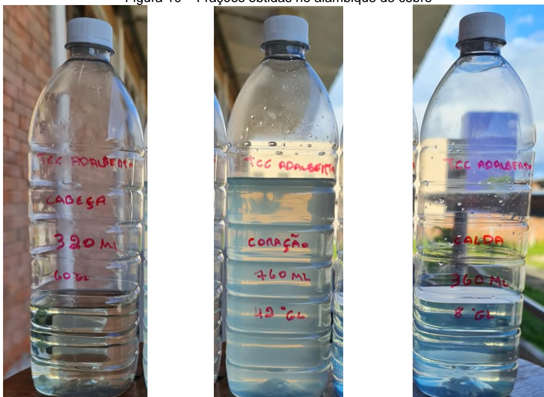
Figura 10 – Frações obtidas no alambique de cobre
