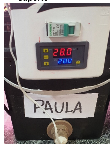
i. Controlador de temperatura com 2 pontos de energia Temperatura setada (EM AZUL) Temperatura da água na dorna (EM VERMELHO)
