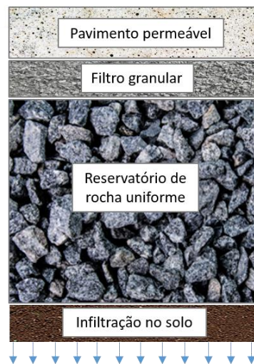
Figura 3 – Camadas de um Pavimento Permeável
