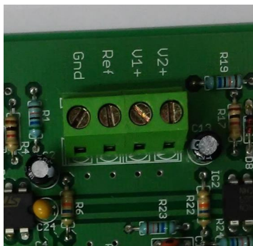
Figura 57. Imagem aproximada dos canais de entrada do Amplificador.
