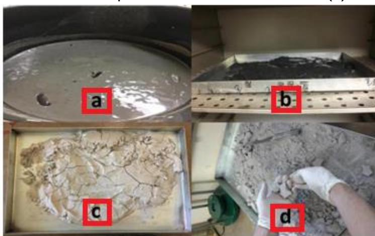
Figura 7: Coleta e tratamento do resíduo de rochas ornamentais: material em forma de lama (a), material na estufa para secagem (b), material após secagem (c) e material em processo de destorroamento (d).
