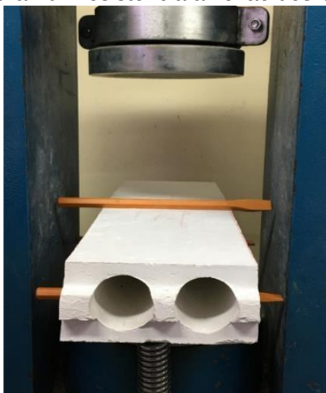
Figura 20: Resistência à flexão dos blocos.
