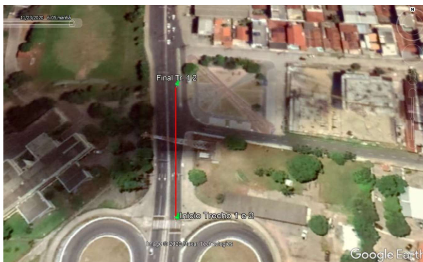
Figura 7 – Exemplo de identificação das coordenadas UTM nos pontos centrais das faixas de rolamento e extensão: Trecho 1 (faixa da esquerda) e trecho 2 (faixa da direita)
