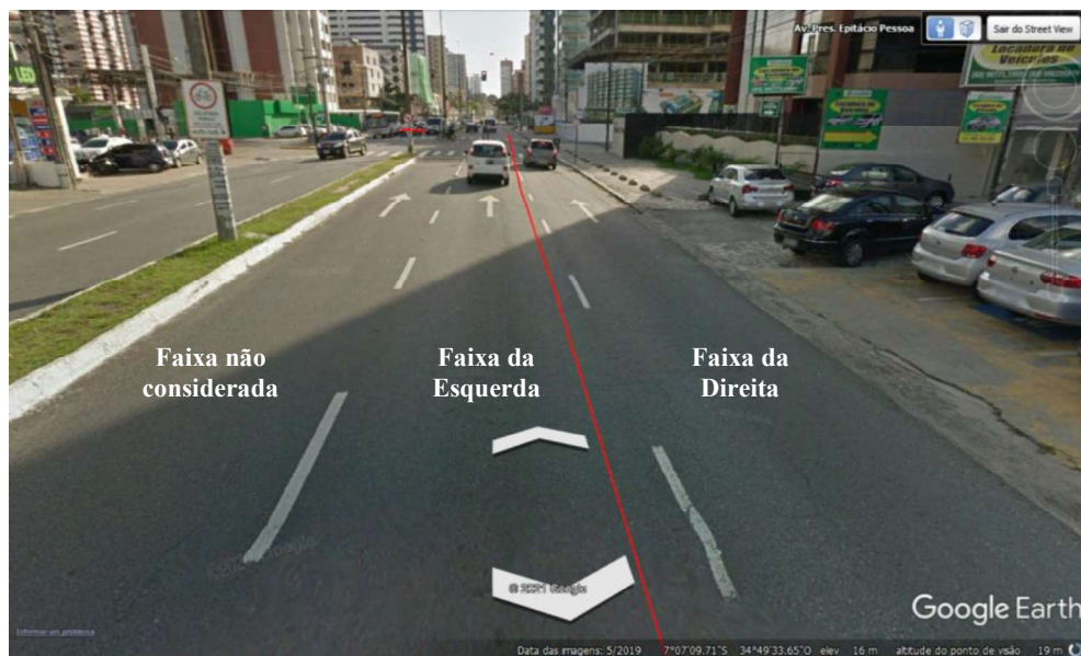
Figura 8 – Exemplo de nomeação de faixas como esquerda e direita para o levantamento em vias com 3 faixas
