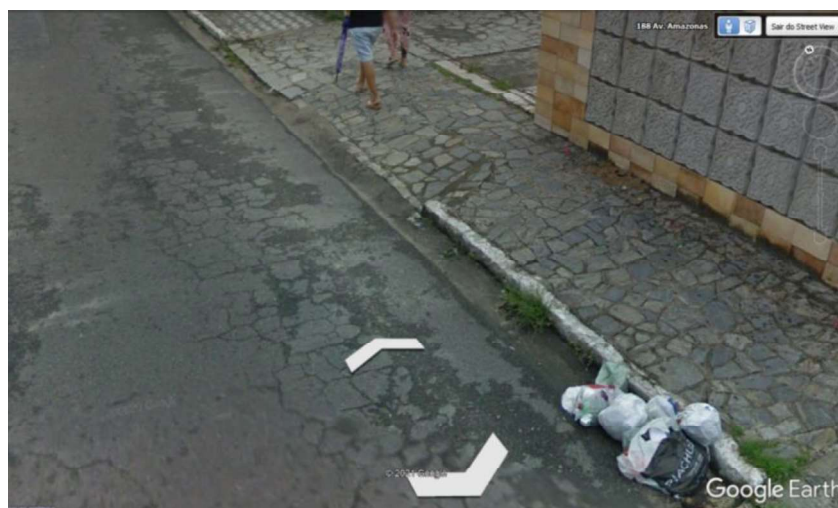
Figura 22 - Pavimento em Condições Péssimas e Influência de Lixo na Sarjeta (Trecho 53)
