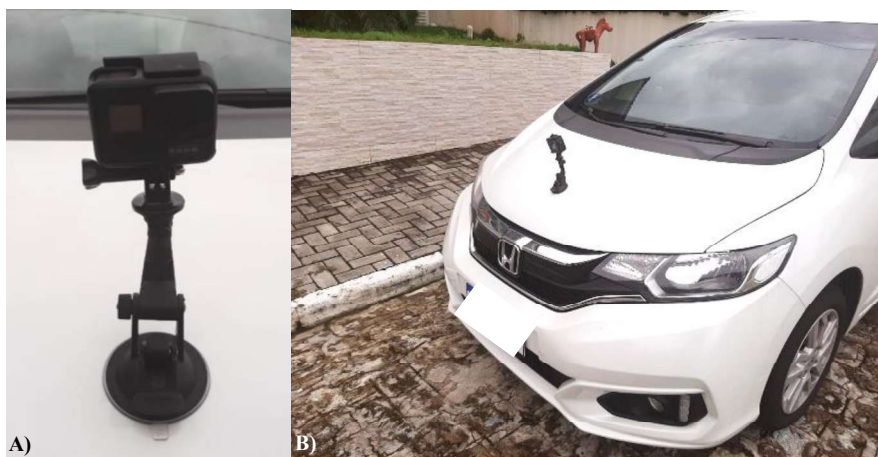
Figura 6 – Levantamento de Dados Automatizado - A: Detalhe da câmera, B: Câmera acoplada ao veículo
