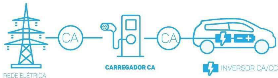
Figura 3.1 – Processo de carregamento de VEs em corrente alternada. [Fonte: NeoCharge]
