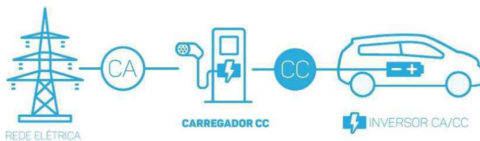
Figura 3.2 – Processo de carregamento de VEs em corrente contínua. [Fonte: NeoCharge]
