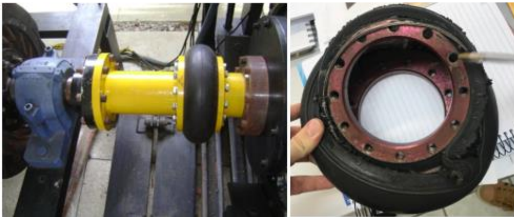
Figura 25 - Acoplamento Antaris AT versão especial acoplado e espaçador após ruptura.
