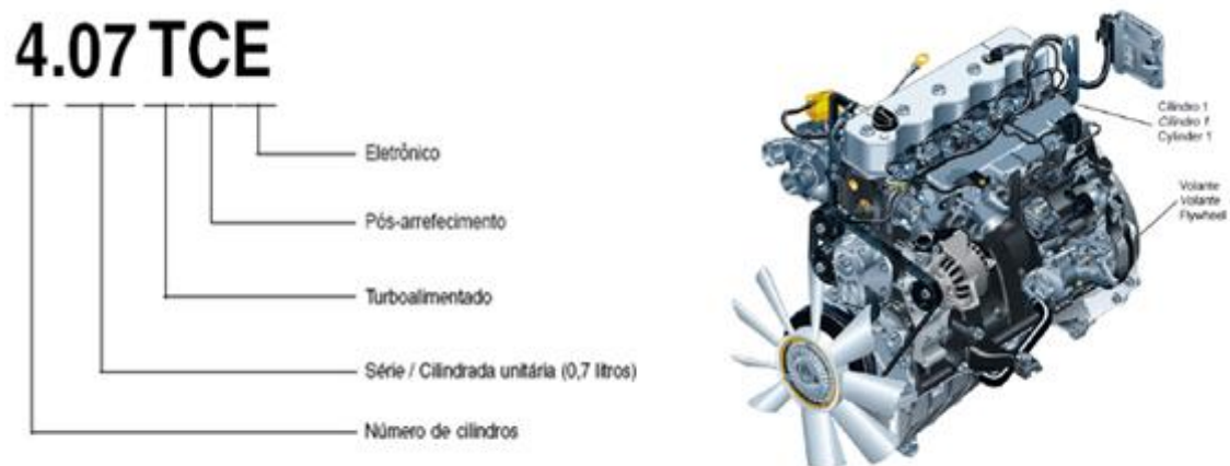
Figura 11 – Identificação do Motor MWM 4.07 TCE
