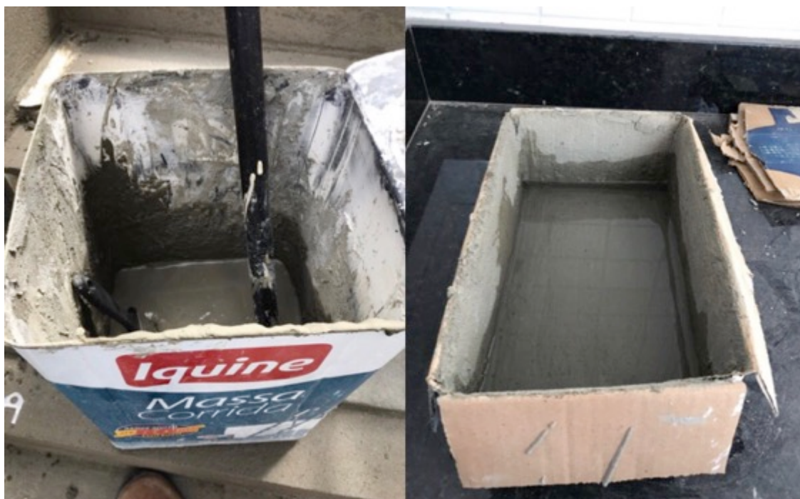
Figura 23 - Teste de estanqueidade com argamassa polimérica
