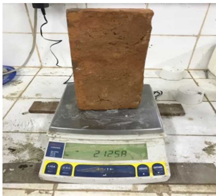
Figura 20 – Determinação da massa seca do tijolo
