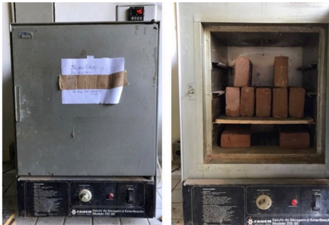
Figura 19 - Secagem em estufa na temperatura de 45oC
