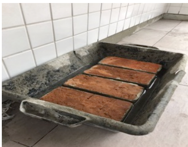
Figura 22 – Corpos de prova em lâmina d'água
