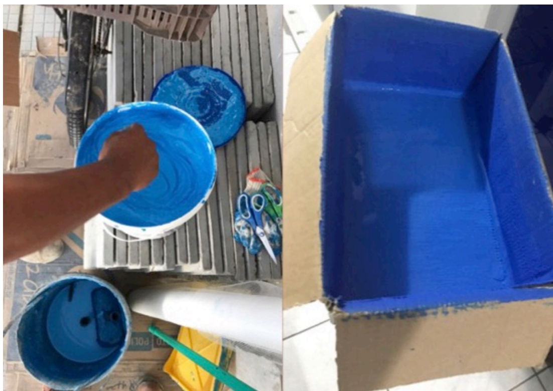
Figura 24 – Teste de estanqueidade com membrana acrílica
