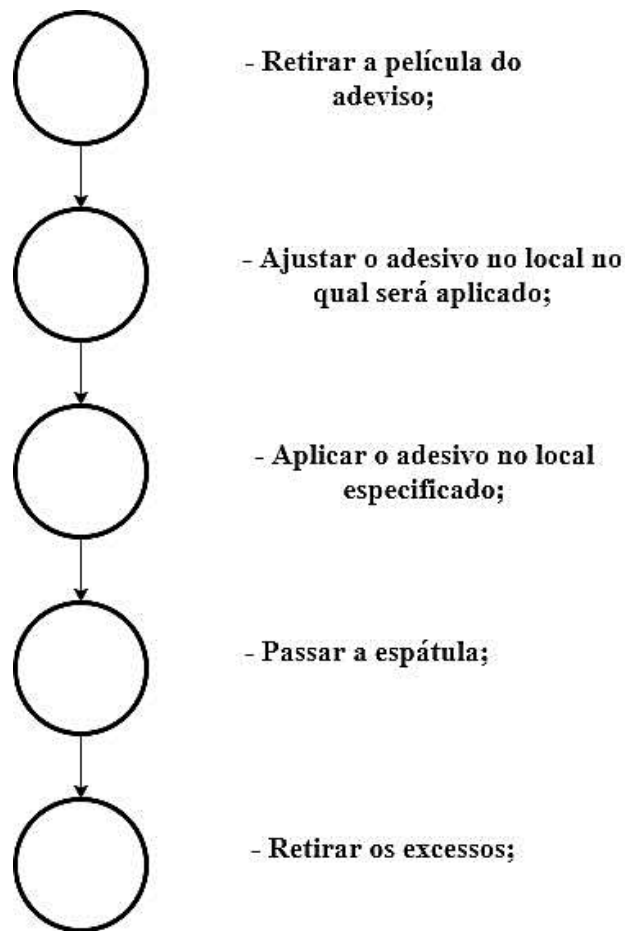
Figura 2 - Fluxograma de adesivagem
