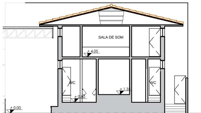
Imagem 27: Trecho do corte JJ presente no desenho 31 da prancha 10 com locação proposta para caixa d'água Fonte: Acervo da Pesquisa
