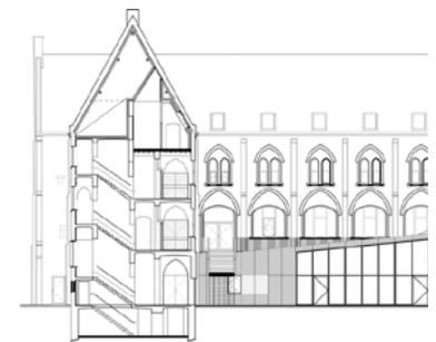
*Corte esquemático de parte da edificação, demonstrando as formas e espaços gerados a partir de estruturas arqueadas e abobadadas do edifício original.*
