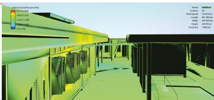
As simulações realizadas no software Flow Design tiveram como condicionantes a velocidade do vento predominante (sudeste), com a velocidade de 20km/h.
