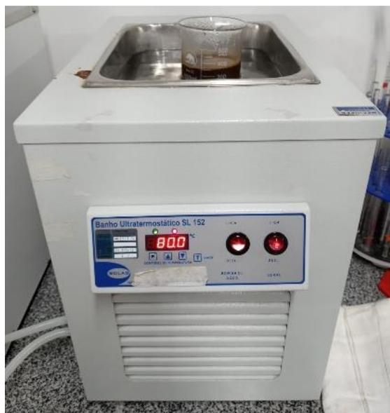
Na lavagem, foi colocado 50 g de adsorvente no becker e foi adicionado 150 mL de água destilada e deixou aquecer durante 1 h na temperatura de 80 °C no banho maria. Após o aquecimento no banho maria foi retirado o becker e filtrado utilizando a bomba a vácuo.
