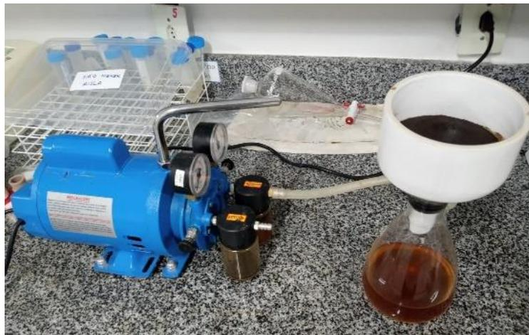
Figura 5.2 - Tratamento da borra de café usando filtração a vácuo após última lavagem
