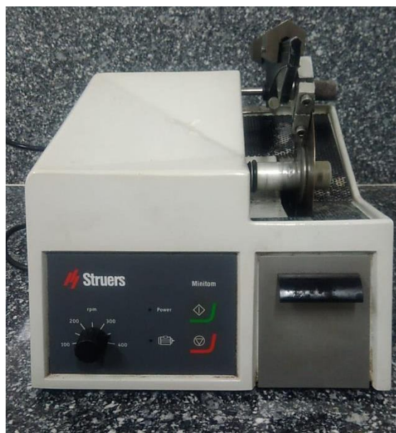
Figura 26. Máquina de corte STRUERS MINITOM, com disco de diamante.
