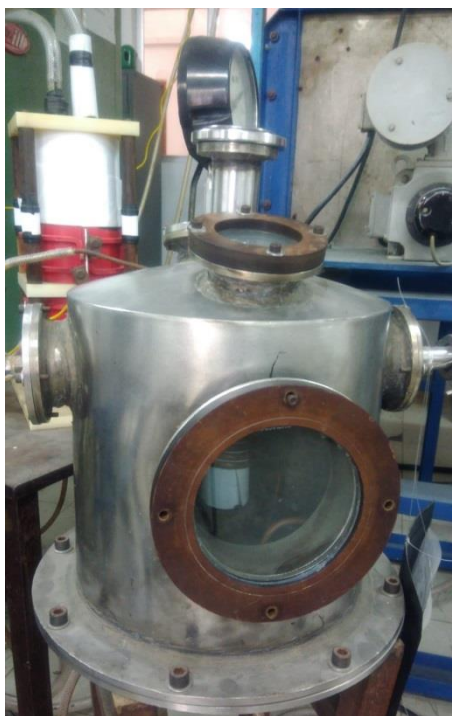
Figura 24. Forno de indução com atmosfera controlada.
