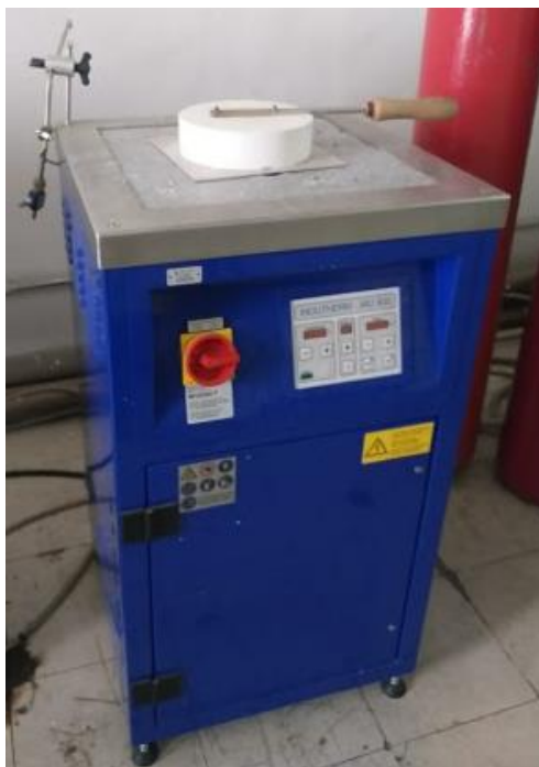
Figura 22. Forno de indução sem atmosfera controlada.
