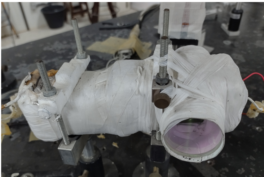
Figura 4.14: Célula utilizada para medir o processo de aprisionamento radiativo ressonante e sua relação com a difusão anômala dos fótons oriundos do feixe laser.
