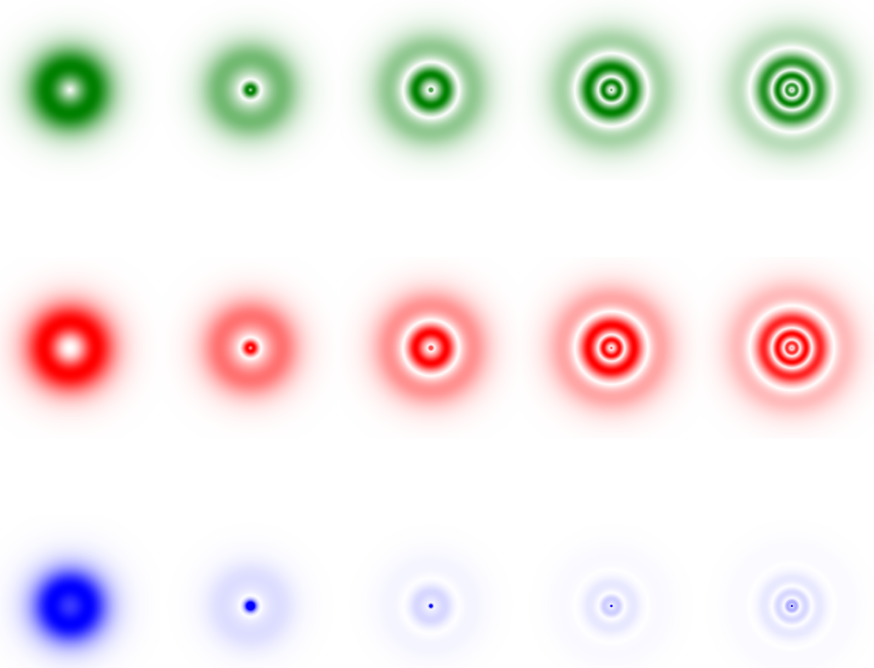
Figura 7.9 A componente radial do campo elétrico (verde/cima), campo magnético (vermelho/meio) e densidade de energia (azul/baixo) associado ao modelo descrito pela função (7.66) no plano, com x \in [-4, 4] e y \in [-4, 4] , para v = n = 1 , k = 0, 1, 2, 3 e 4, da esquerda para direita.
