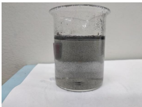
Figura 50. Foto dos NaMMF-AG1 (0,03 g/L, 100% de NTCPM), funcionalizado com quitosana.
