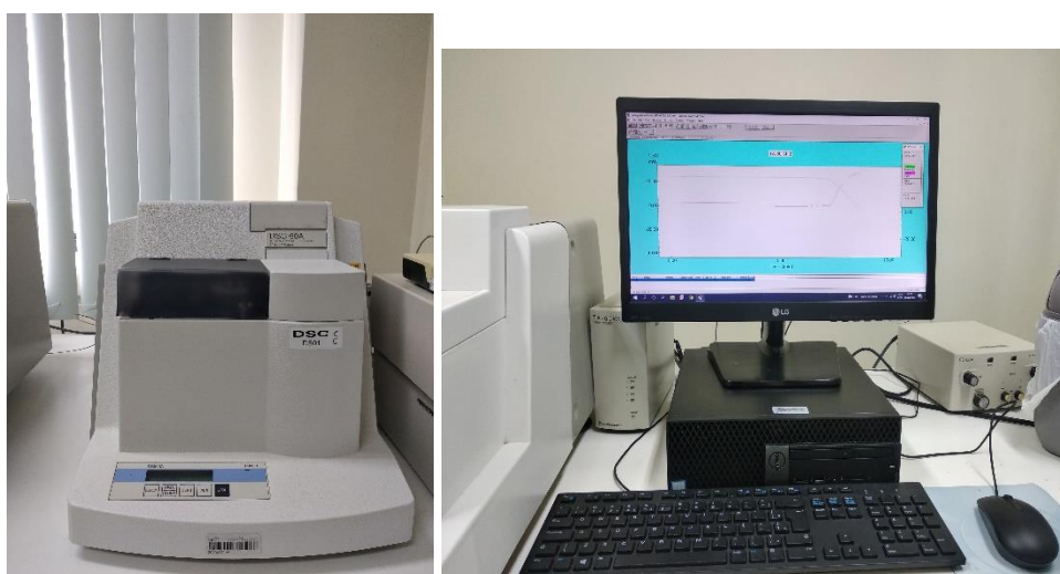
Figura 44. Bancada DSC, à esquerda (DSC); à direita, computador com aquisição de dados.
