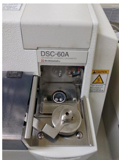
Figura 45. Porta amostras do DSC. À esquerda, panelinha com material de referência (ar); à direita, material a ser analisado.
