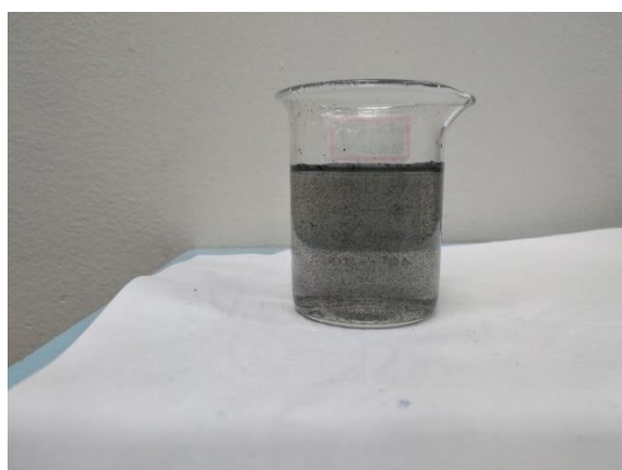
Figura 55. Foto dos NaMMF-AG6 (0,06 g/L, 75% NTCPM e 25% OG), funcionalizado com quitosana.
