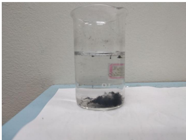
Figura 58. Foto dos NaMMF-AG3 (0,03 g/L, 75% NTCPM e 25% OG), funcionalizado com quitosana após 1h.
