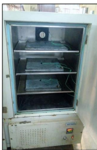
Figura 18. Câmara fria com incorporadas com bandejas de MMF nas prateleiras. Fonte: (TK e Raj, 2018).
