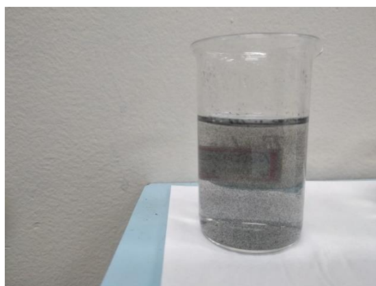
Figura 52. Foto dos NaMMF-AG3 (0,03 g/L, 75% NTCPM e 25% OG), funcionalizado com quitosana.
