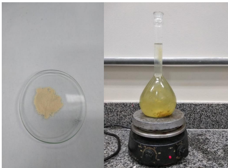
Figura 35. Quitosana em pó (à direita); solução de quitosana em agitação magnética (à esquerda).
