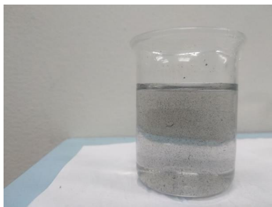
Figura 69. Foto dos NaMMF-AG8 (0,03 g/l, 50% NTCPM e 50% OG), funcionalizado com ácidos.
