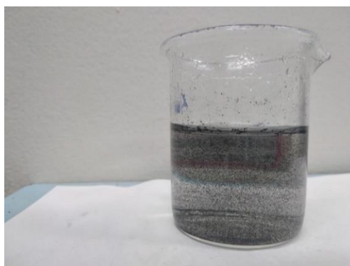
Figura 51. Foto dos NaMMF-AG2 (0,03 g/L, 50% NTCPM e 50% OG), funcionalizado com quitosana.
