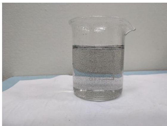
Figura 68. Foto dos NaMMF-AG7 (0,03 g/l, 100% de NTCPM), funcionalizado com ácidos.
