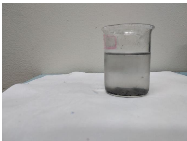
Figura 60. Foto dos NaMMF-AG5 (0,06 g/L, 50% NTCPM e 50% OG), funcionalizado com quitosana após 1h.
