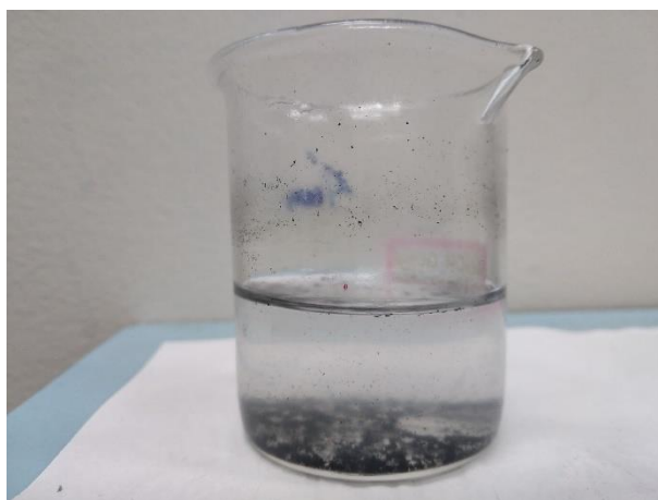
Figura 57. Foto dos NaMMF-AG2 (0,03 g/L, 50% NTCPM e 50% OG), funcionalizado com quitosana após 1h.
