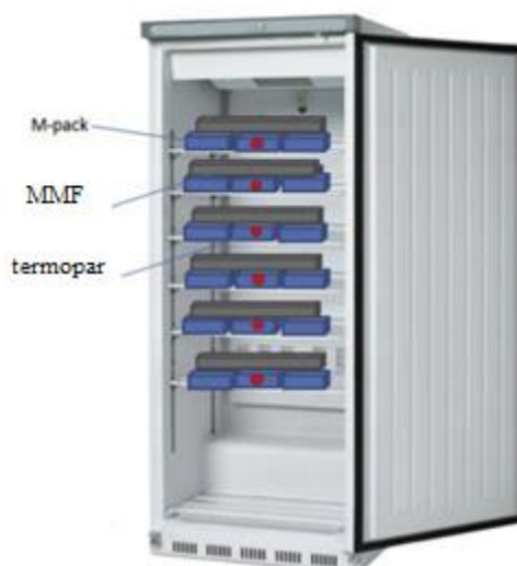
Figura 21. Esquema do freezer mostrando as posições dos termopares, a colocação dos M-packs (carga térmica) e MMF. Fonte: (Abdolmaleki et al. , 2020).
