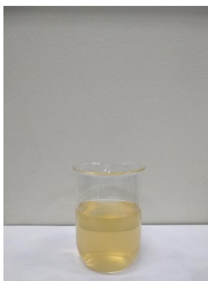
Figura 36. Solução de quitosana após o processo de filtragem.
