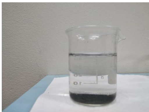
Figura 74. Foto dos NaMMF-AG7 (0,03 g/l, 100% de NTCPM), funcionalizado com ácido após 1h.
