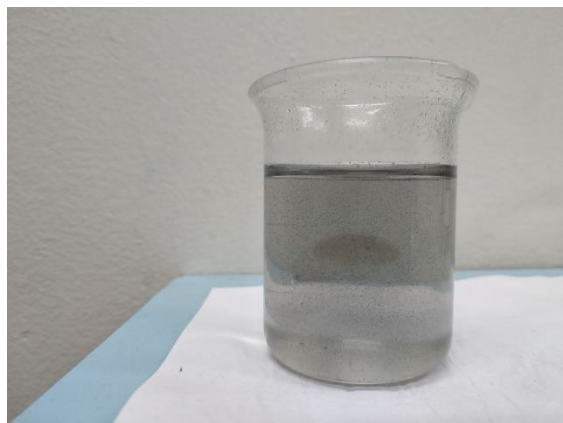
Figura 70. Foto dos NaMMF-AG9 (0,03 g/l, 75% NTCPM e 25% OG), funcionalizado com ácidos.
