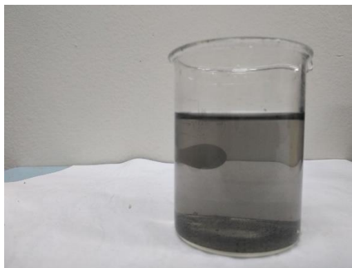
Figura 78. Foto dos NaMMF-AG11 (0,06 g/l, 50% NTCPM e 50% OG), funcionalizado com ácido após 1h.
