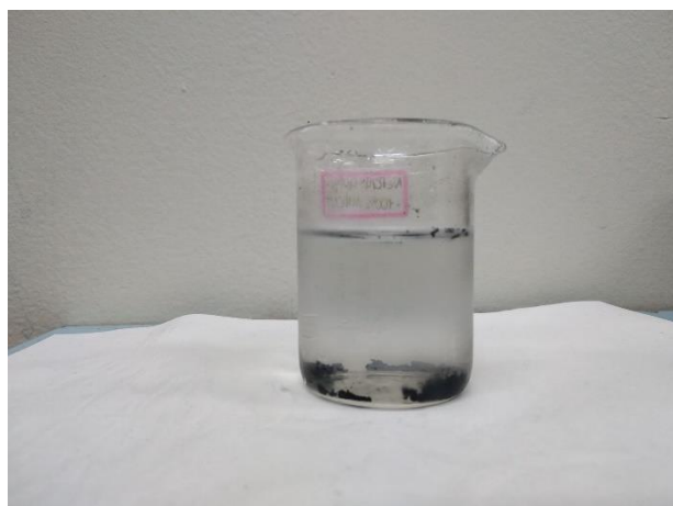
Figura 59. Foto dos NaMMF-AG4 (0,06 g/L, 100% de NTCPM), funcionalizado com quitosana após 1h.
