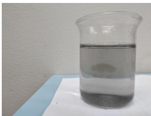
Figura 76. Foto dos NaMMF-AG9 (0,03 g/l, 75% NTCPM e 25% OG), funcionalizado com ácido após 1h.
