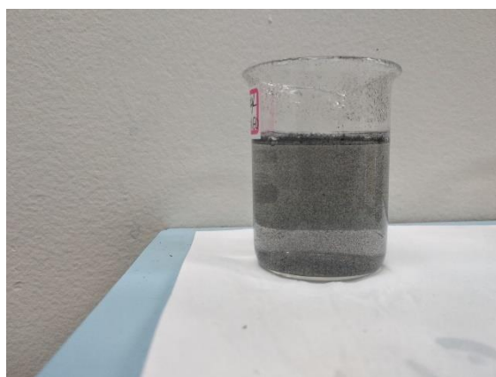
Figura 54. Foto dos NaMMF-AG5 (0,06 g/L, 50% NTCPM e 50% OG), funcionalizado com quitosana.
