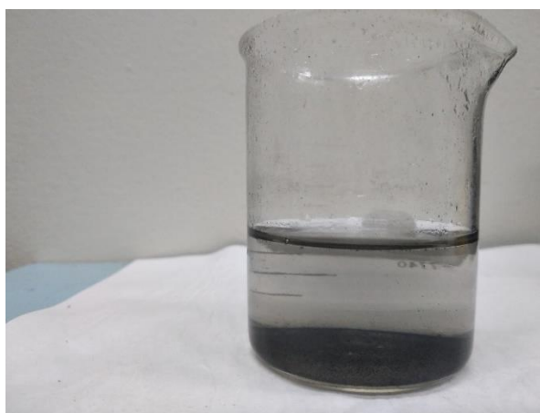
Figura 79. Foto dos NaMMF-AG12 (0,06 g/l, 75% NTCPM e 25% OG), funcionalizado com ácido após 1h.
