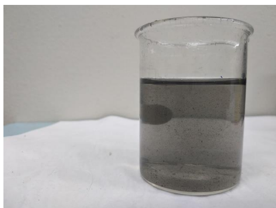
Figura 72. Foto dos NaMMF-AG11 (0,06 g/l, 50% NTCPM e 50% OG), funcionalizado com ácidos.
