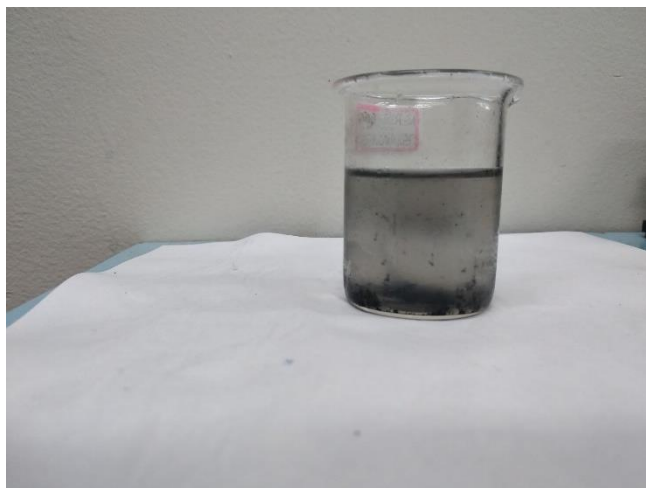
Figura 61. Foto dos NaMMF-AG6 (0,06 g/L, 75% NTCPM e 25% OG), funcionalizado com quitosana após 1h.
