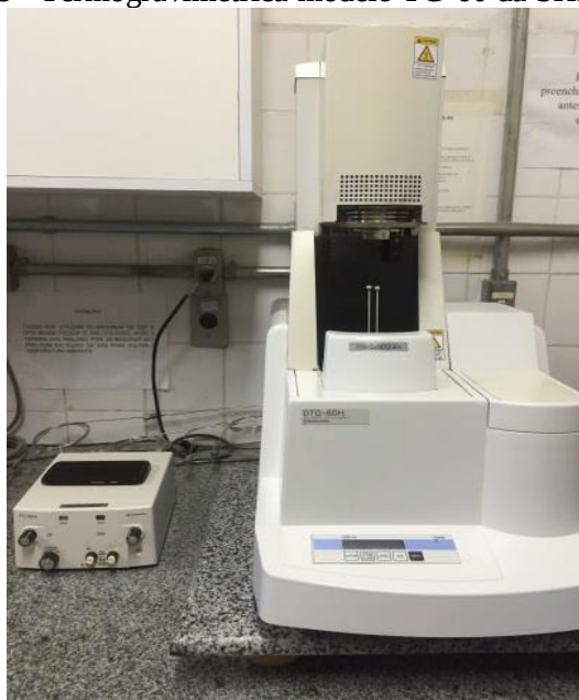
Figura 13 - Termogravimétrica modelo TG-60 da SHIMADZU.
