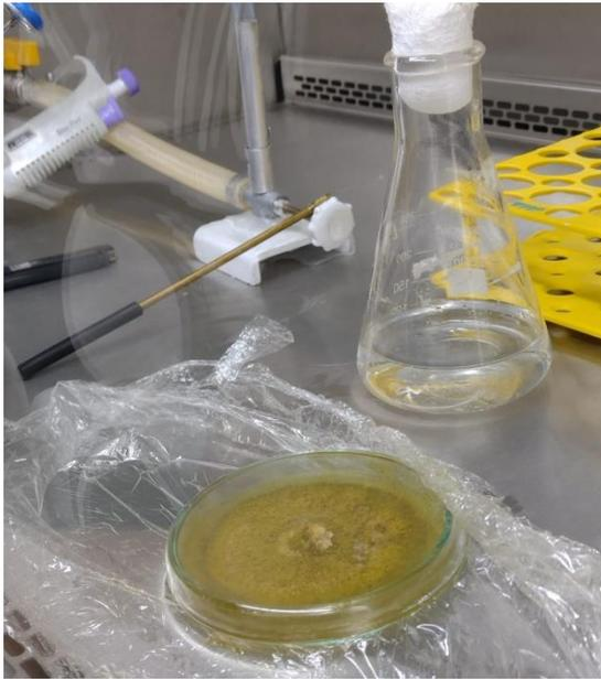
Legenda: (A) Placa de Petri com a suspensão de conídios; (B) Frasco Erlenmeyer com a solução de Tween 80 a 0,3% (v/v); (C) Alça de auxílio para retirada de conídios.
