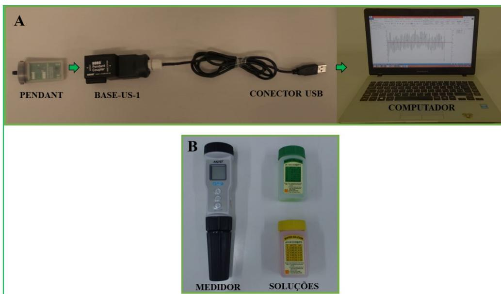
Figura 12. Equipamentos utilizados para determinar a temperatura (HOBO) e o potencial hidrogeniônico (medidor de pH). Fonte: LIRA, E. B., 2020.
