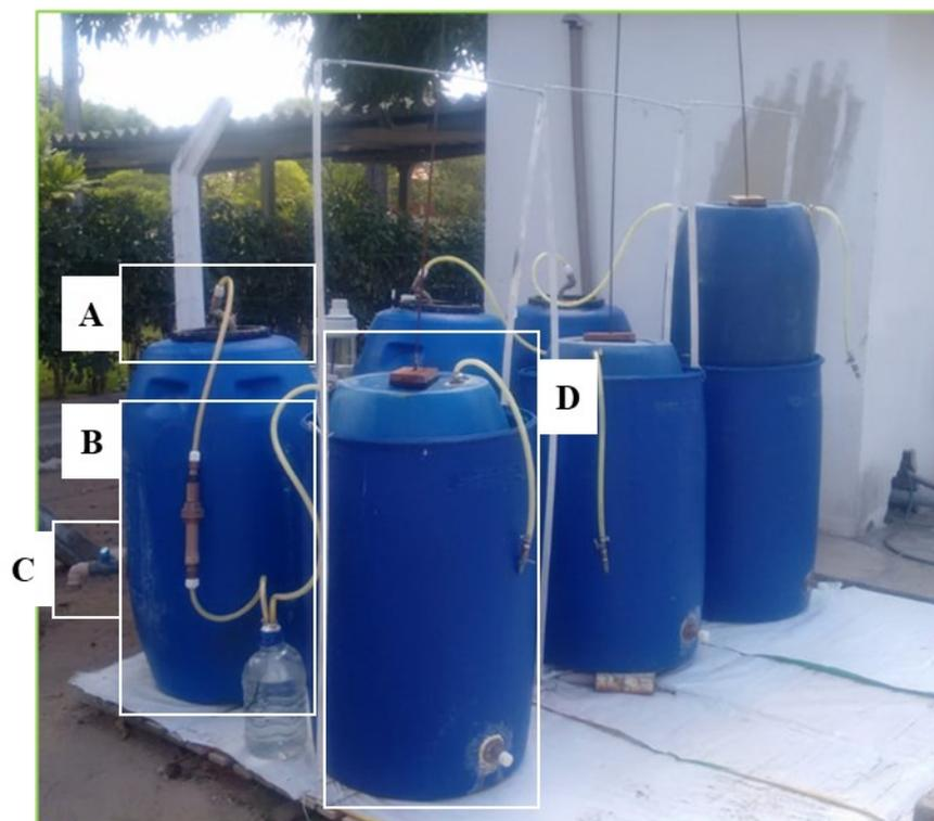
Figura 10. Biodigestores caseiros adaptados do modelo indiano utilizados na pesquisa. Fonte: LIRA, E. B., 2020.
