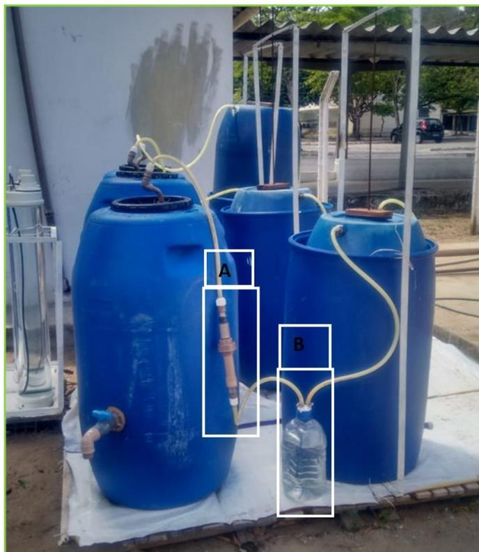
Figura 11. Imagens dos sistemas de purificação de biogás dos biodigestores.
