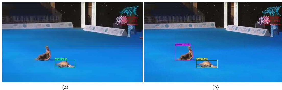
Figura 9 - Detecção do 1620º quadro do vídeo 01, onde as detecções estão marcadas por caixas delimitadoras marcadas nas cores verde, roxo e amarelo. Na figura (a) há uma classe detectada, barco em verde com precisão 0.36. Na figura (b) há duas classes detectadas, pessoa em roxo com precisão 0.52 e cachorro em amarelo com precisão 0.83.
