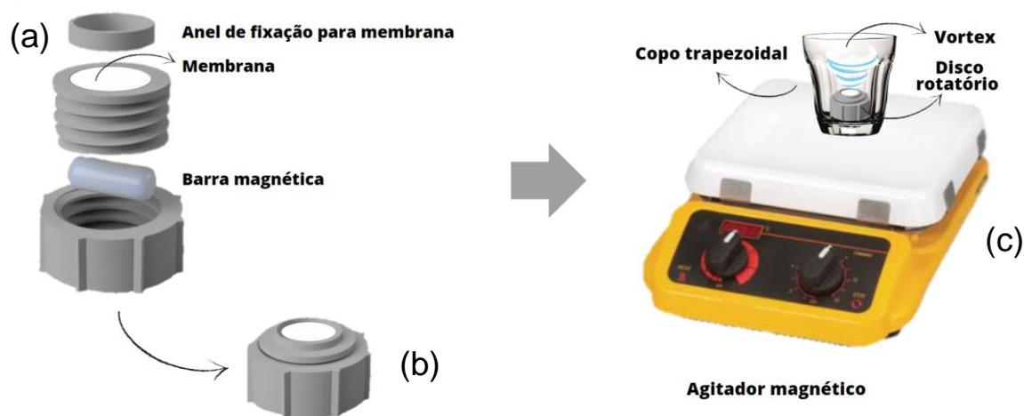
Figura 10 – (a) Partes do disco rotatório que condiciona a membrana de nylon; (b) Montagem do disco rotatório; (c) Extração por sorção em disco rotatório em copo trapezoidal sob agitação.
