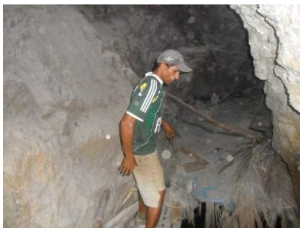
Figura 40: Como é possível observar, as condições de trabalho nas banquetas são consideravelmente degradantes e insalubres. Além do alto risco de desabamentos, há possibilidade de ocorrência de outros acidentes, decorrentes, por exemplo, da improvisação de pontes com tábuas de madeira.
