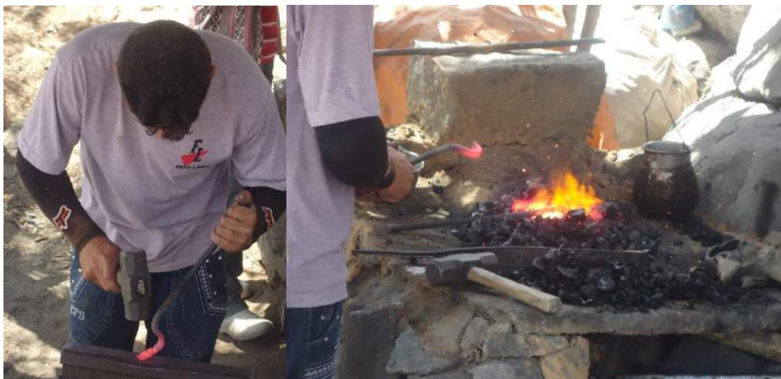
Figura 42: Trabalhador garimpeiro adaptando, por meio da utilização de fogo em brasa e marreta, um vergalhão que será improvisado como ferramenta de trabalho na exploração mineral de granitos.
