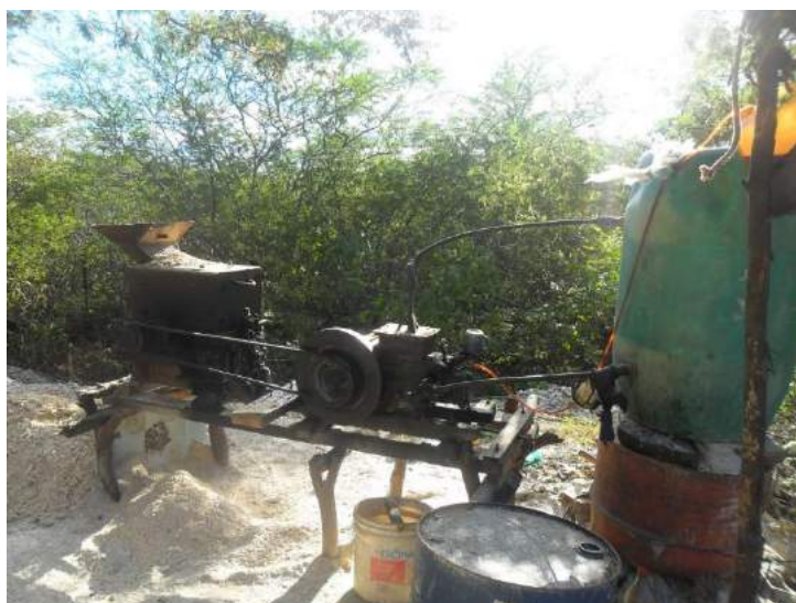
Figura 54: Equipamento utilizado para moer e desagregar materiais contidos nas rochas que consiste em um primeiro processo de beneficiamento mineral.
