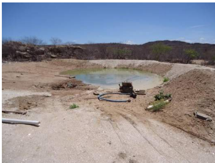
Figura 49: Garimpagem de tantalita a partir do uso de água e bomba d'água na divisa entre os municípios de Frei Martinho e Picuí. Fonte: Trabalho de Campo, novembro de 2013, divisa entre Frei Martinho-PB e Picuí-PB.
