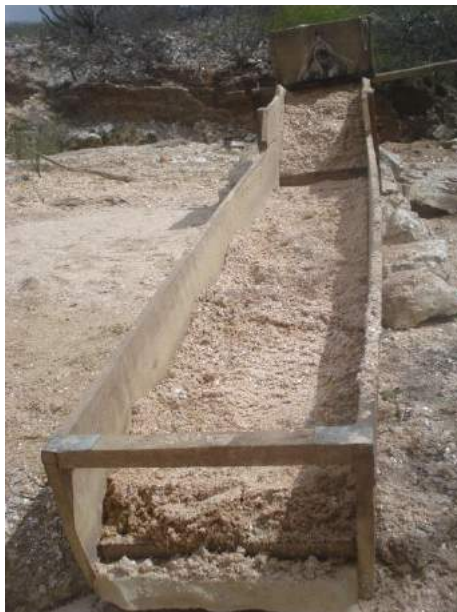
Figura 52 – “Caixa”, Utilizada por Garimpeiros na Garimpagem de Tantalita
