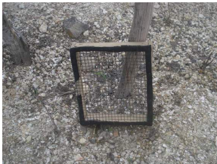
Figura 51: Ferramenta de trabalho comumente utilizada junto à bateia na garimpagem de tantalita em córregos e riachos da região.
