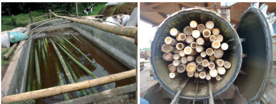
Figura 09 - Processo de tratamento do bambu (imersão a esquerda, autoclave a direita).
