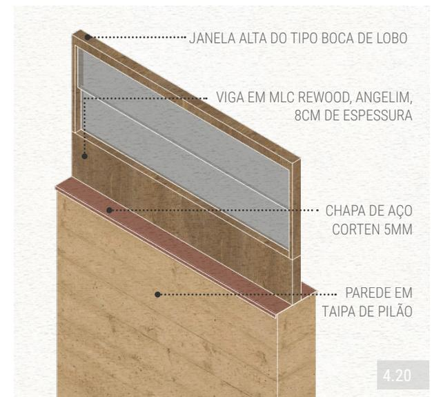
FIGURA 4.20: Viga de MLC apoiada em eixo de parede em taipa. Fonte: Produzido pela autora.
