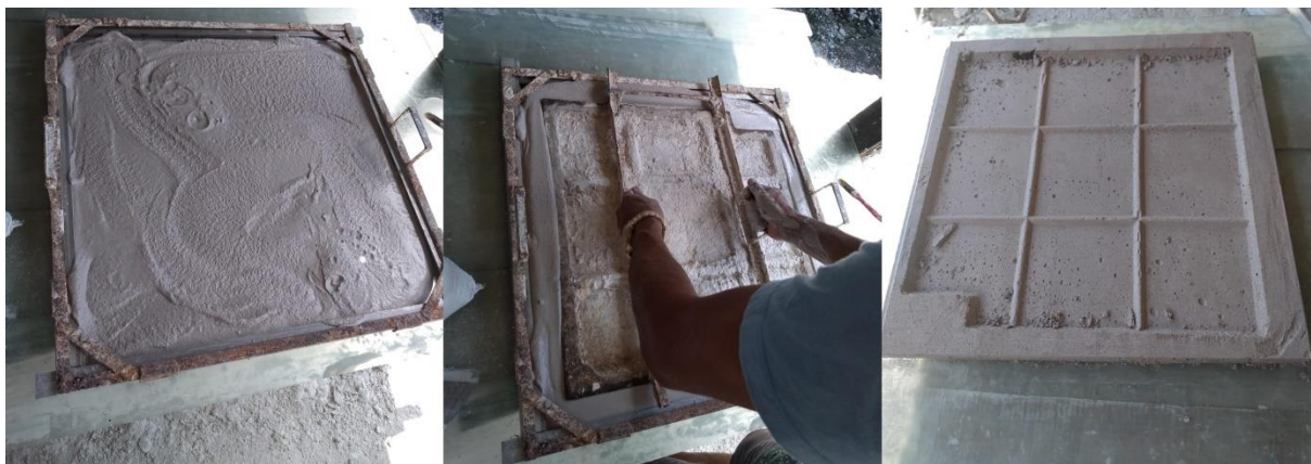
Figura 14 - Produção da placa 65x65cm com gesso e bagaço
