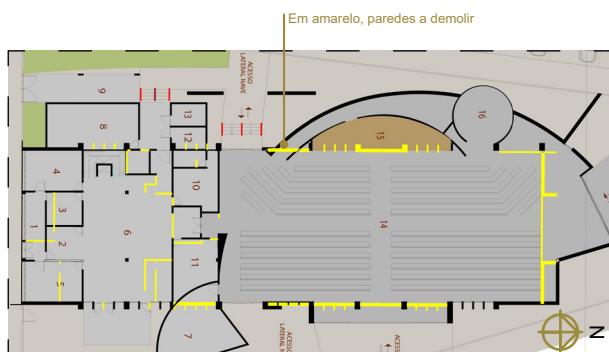
Figura 78 : Planta de Demolição proposta Fonte: Elaboração da autora segundo Projeto
