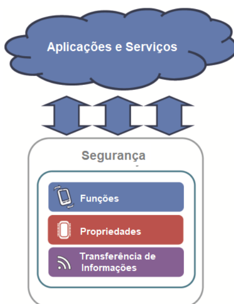
Figura 1 – Representação do conceito de coisa conforme o padrão IEEE Std 2413-2019.
