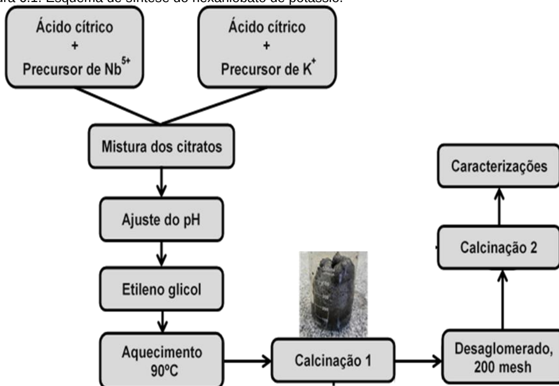
Figura 6.1. Esquema de síntese do hexaniobato de potássio.
