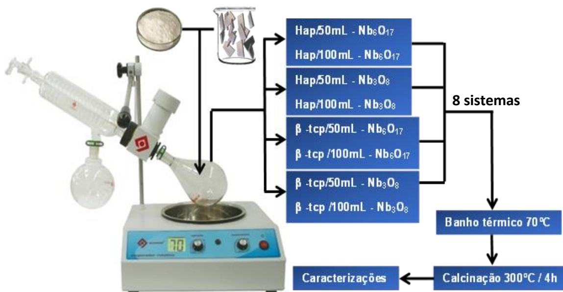
Figura 6.4. Procedimento para a elaboração dos compósitos por impregnação
