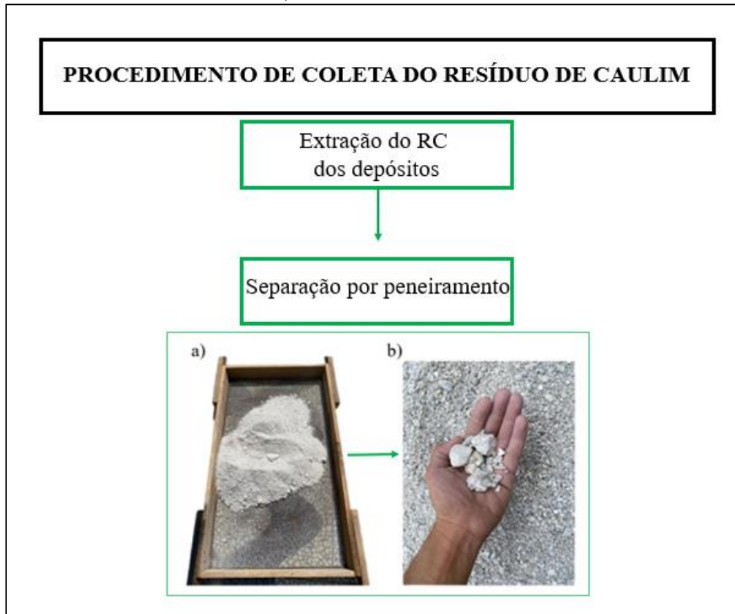
Figura 8 - Processo esquemático para obtenção da birra: a) peneiramento da amostra e b) amostra obtida.
