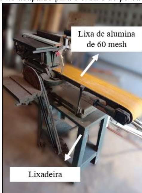
Figura 22 - Equipamento adaptado para o ensaio de perda de massa por abrasão.
