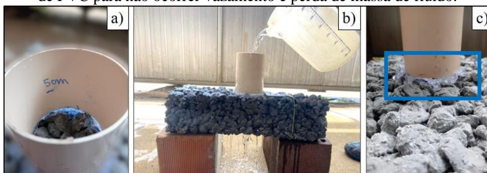
Figura 20 - Ensaio do coeficiente de permeabilidade: a) Marca para controle da altura da coluna d'água; b) Escoamento da água e c) Silicone aplicado na interface concreto/tubo de PVC para não ocorrer vazamento e perda de massa de fluido.
