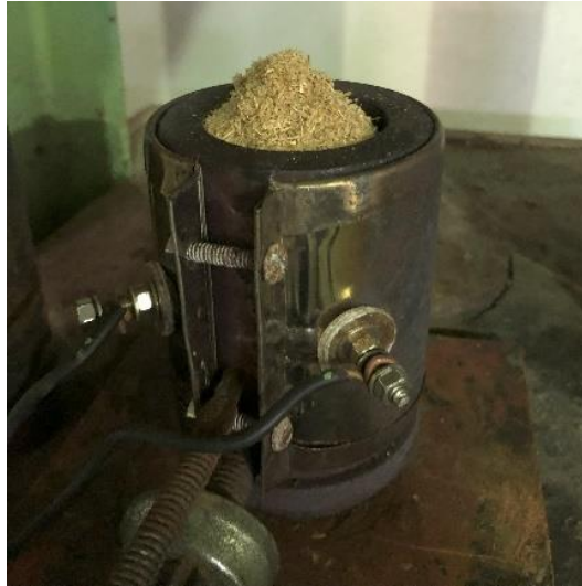
Figura 4 – Matriz da prensa com amostra de bagaço de Cana-de-açúcar
