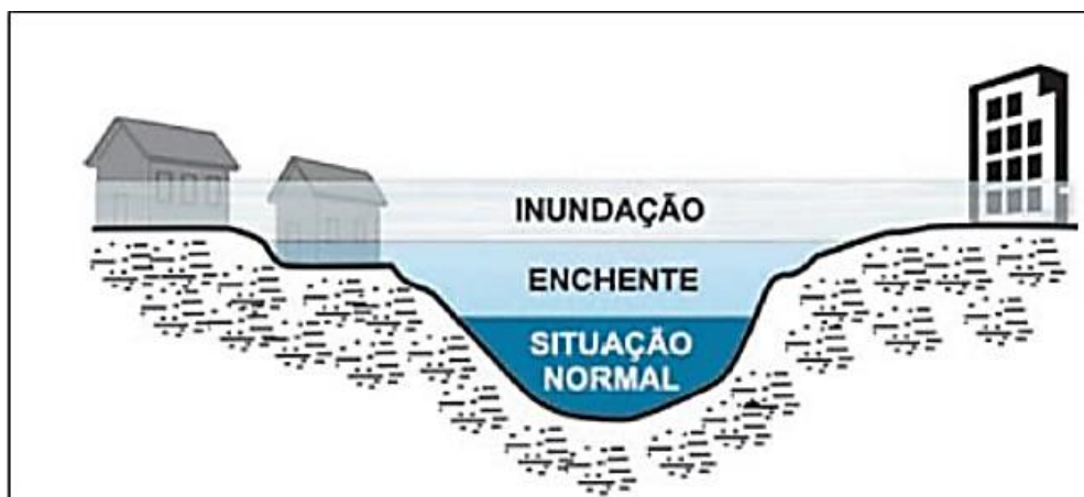
Figura 14 – Perfil esquemático do processo dos desastres do tipo enchente e inundação nas cidades.
