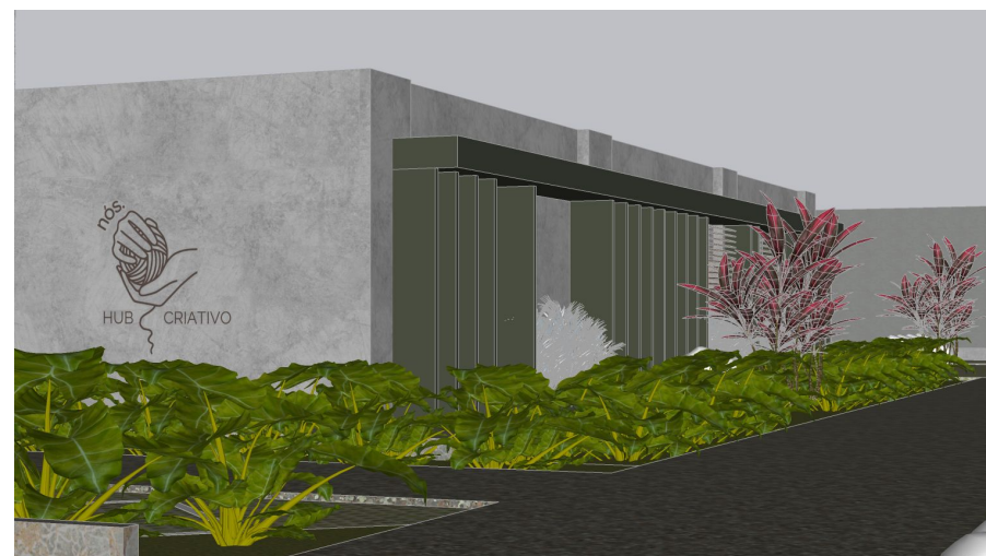
FIGURA 84: IMAGEM ILUSTRANDO A FACHADA OESTE MARCADA POR ELEMENTOS COMO MARQUISES, BRISSES VERTICAIS E VEGETAÇÃO. / FONTE : ELABORADO PELA AUTORA
