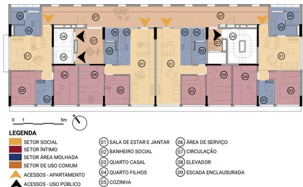
**Figura 15:** Planta baixa do bloco habitacional do tipo torre.
