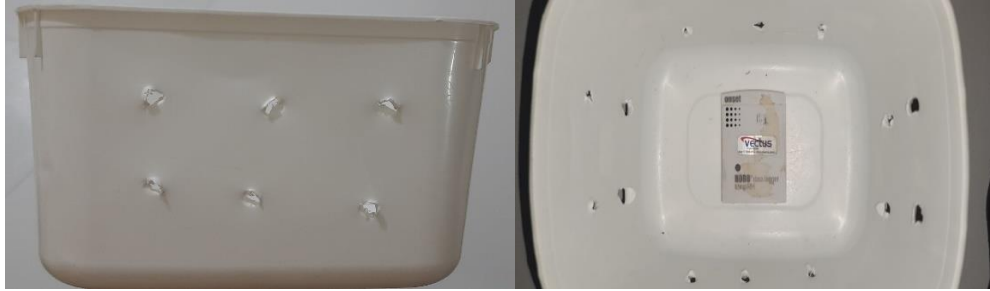
Figura 9: Abrigo plástico utilizado para proteger os sensores data logger utilizados na pesquisa de campo na praça Getúlio Vargas, Patos/PB.
