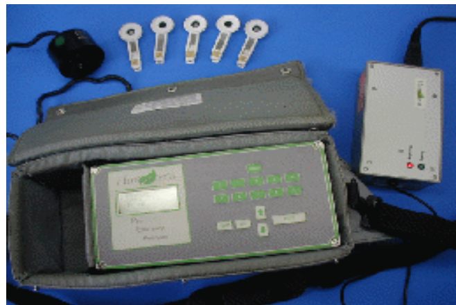
Figura 4. Detector de fluorescência do tipo PEA (Plant Efficiency Analyser). (Fonte: www.agriambi.com.br/sciello ).
