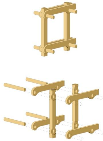
Figura 56 – Encaixe da estrutura
