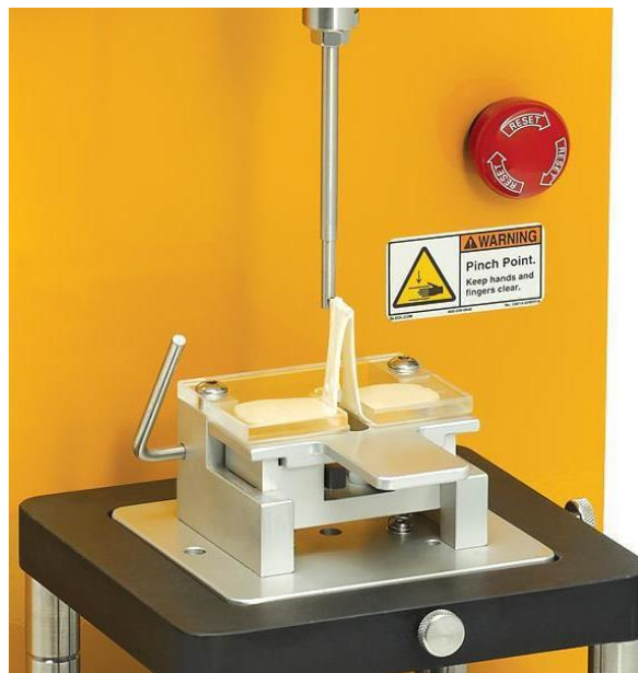
Figura 4 - Análise de extensibilidade da massa por tensão
