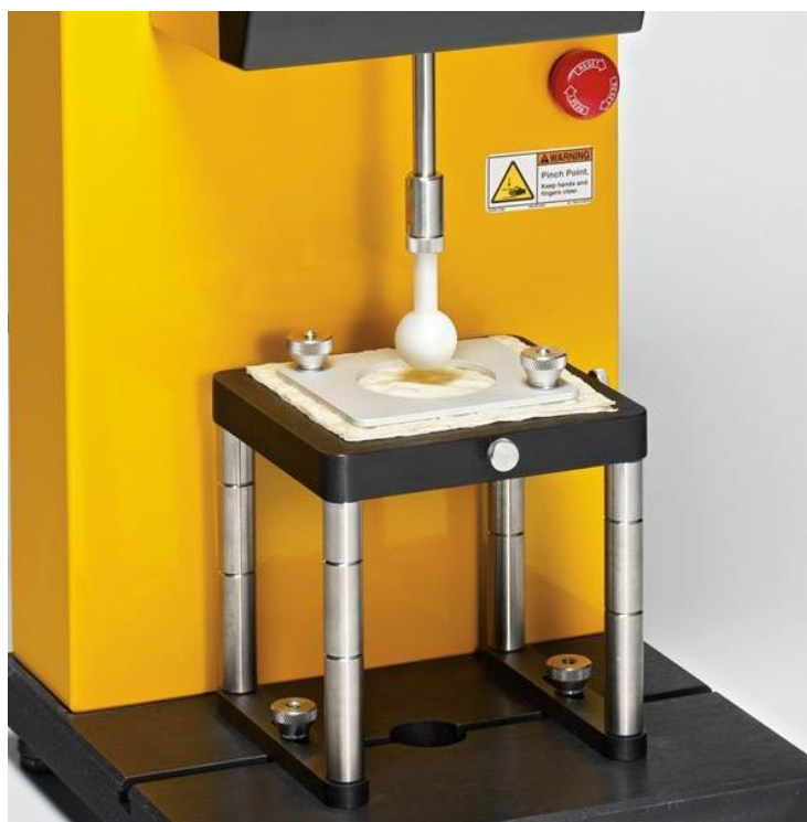
Figura 5 – Análise da extensibilidade da massa por compressão
