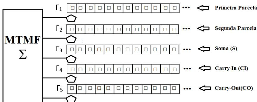
Figura 5 - MT MultiFitas sugerida para a Somadora – Fonte: Autor
