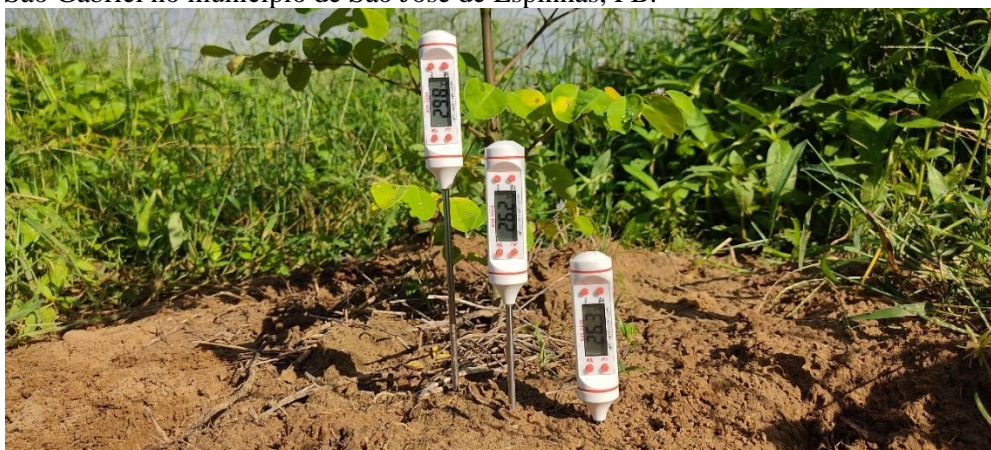
Figura 6. Aferição da temperatura solo (°C), nas três profundidades (0,0; 7,5; 15 cm), realizada na Fazenda São Gabriel no município de São José de Espinhas, PB.
