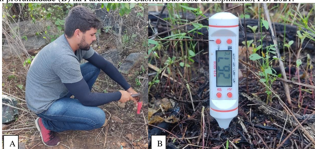
Figura 7. Perfuração do solo para inserção do termômetro (A) e aferição da temperatura do solo em profundidade (B) na Fazenda São Gabriel, São José de Espinharas, PB. 2021.
