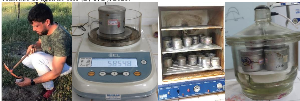
Figura 8. Coleta de solo em área experimental (A) e Procedimentos laboratoriais para determinar o conteúdo de água no solo (B, C, D), 2021.
