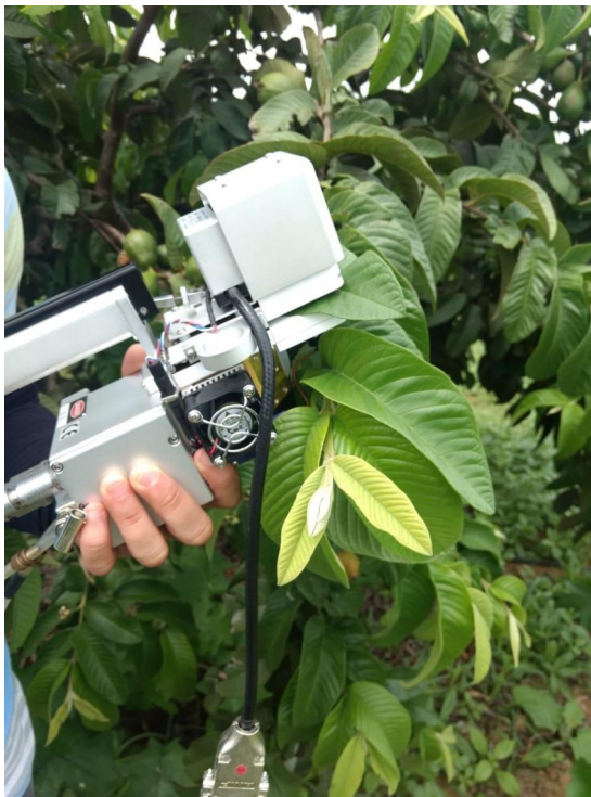
Figura 1. Representação das leituras de troca gasosa e fluorescência da clorofila em goiabeira
