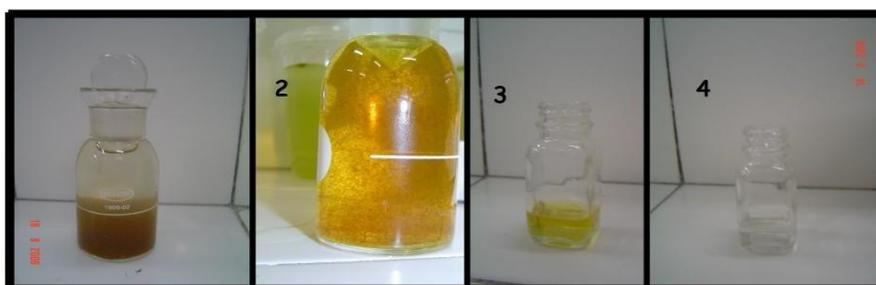
Figuras 1-2. Fixação da quantidade de oxigênio. A cor amarela indica sua presença. Figuras 3-4. Determinação da quantidade do oxigênio dissolvido. O experimento acaba quando o líquido muda de coloração amarela para incolor.
